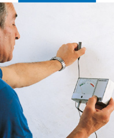
Kontrola zbytkové vlhkosti sádry
